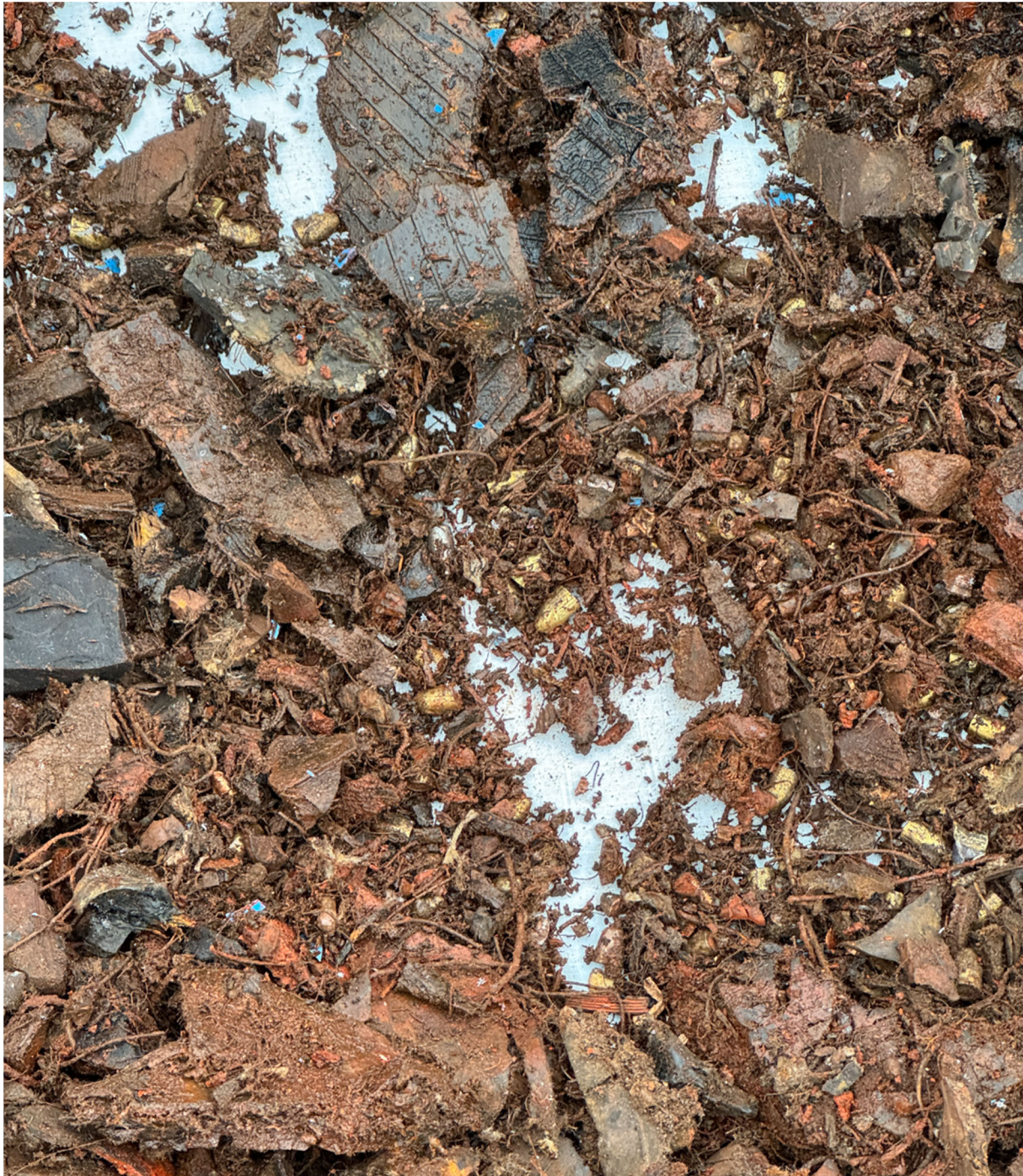
Figur 5 Dekk-klipp og kuler 15-30 cm inn i kulefanget
