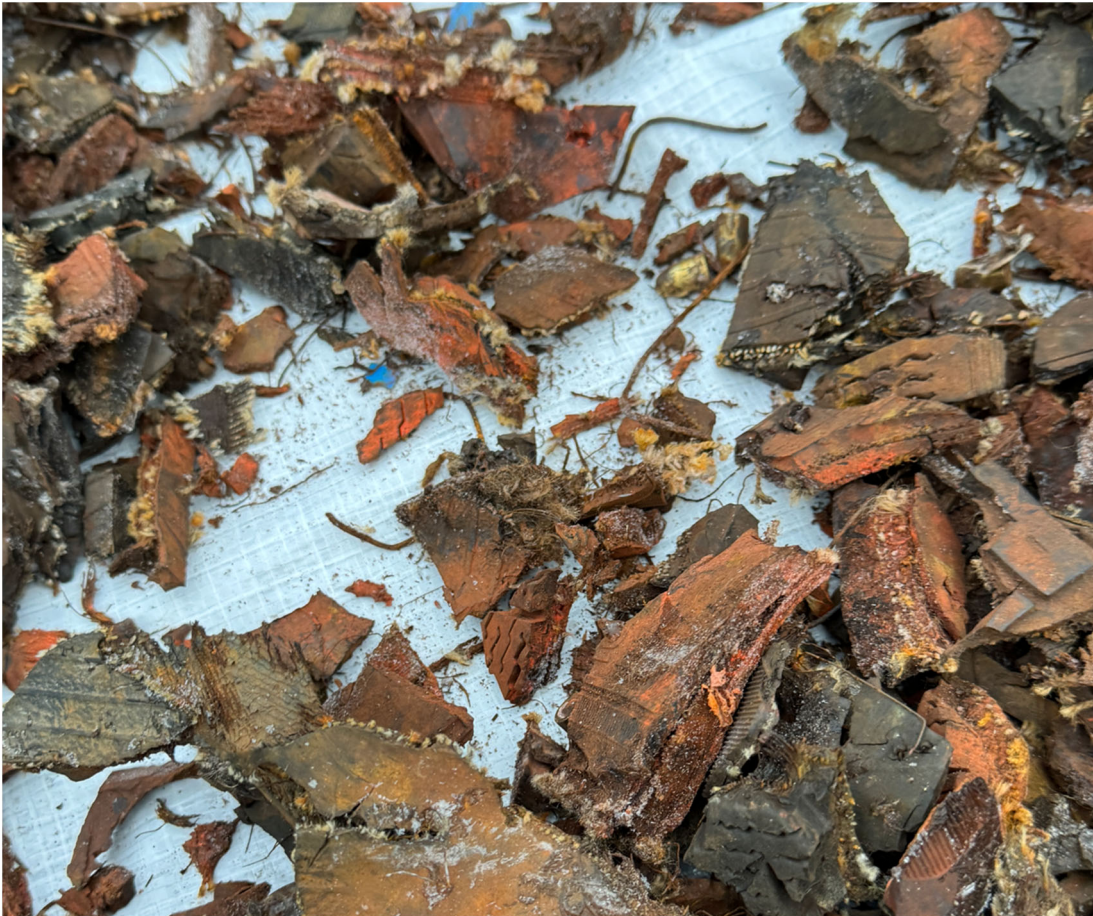
Figur 2 Dekk-klipp 10-15 cm inn i kulefanget
