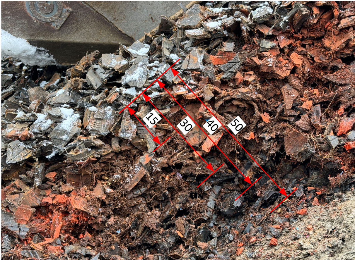
Figur 9 Snitt gjennom kulefanget.
