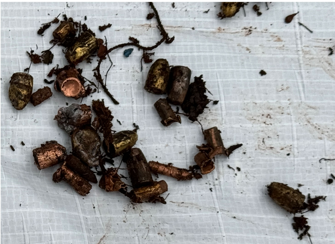
Figur 8 Et utvalg kuler funnet 30-40 cm inn i kulefanget
