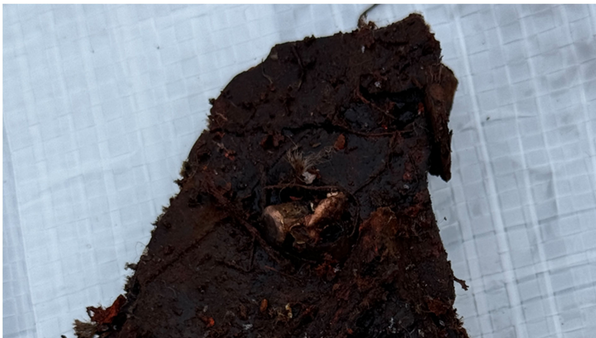
Figur 4 5.56-kule som har satt seg fast i en bit av dekk-klippet
